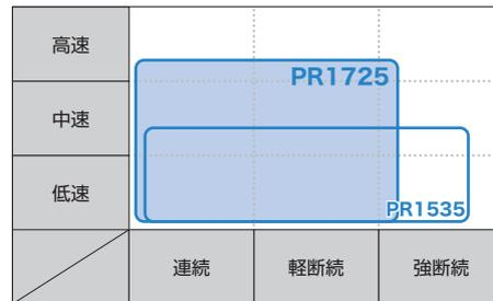
PR1725:高速加工向け。工具集約が可能
